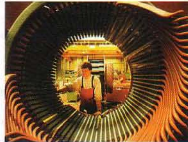
29.8 Un alternador comercial tiene muchas espiras de alambre devanadas alrededor de una estructura con apariencia de barril llamada inducido. El inducido y el alambre permanecen fijos mientras los electroimanes giran sobre un eje (no se muestra) que pasa por el centro del inducido. La fem inducida resultante es mucho mayor que la que se podría obtener con una sola espira de alambre.
